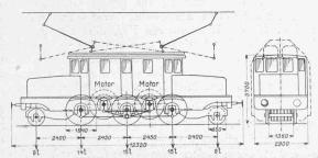
Abb. 2. Typenskizze der Simplon-Lokomotive F<sup>3</sup>/<sub>5</sub>. - 1:200.
