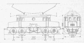
Abb. 3. Typenskizze der Simplon-Lokomotive F4/4. - 1:200.
