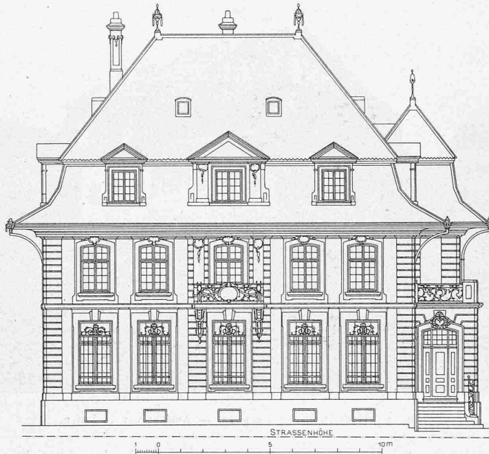
Abb. 10. Fassade gegen die Strasse. — Masstab 1 : 200.
