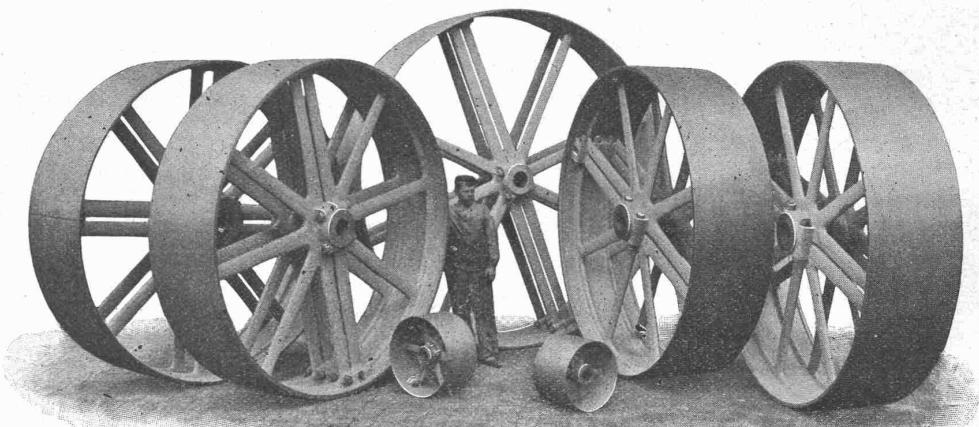
Gusseiserne Riemscheiben für Hauptantriebe, bis 3300 mm Durchmesser geliefert.
