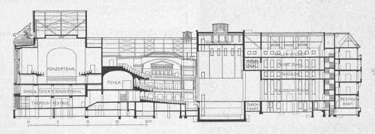
Abb. 3. Längsschnitt durch Konzertsaal, Schauspielhaus und Hintergebäude. - Masstab 1:800.
