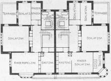
Abb. 3 Grundriss vom Obergeschoss. — 1:400.
