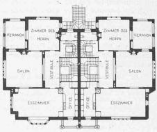
Abb. 2. Grundriss vom Hauptgeschoss. — 1:400.
