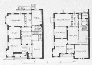
Abb. 2. Grundrisse vom Erdgeschoss und Obergeschoss. — 1:400.
