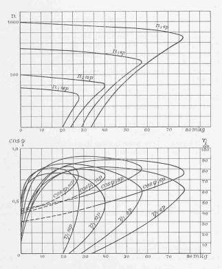
Abb. 2. Betriebskurven eines Drehstrom-Stufenmotors für gleiches Drehmoment.
