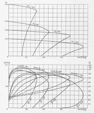
Abb. 3. Betriebskurven eines Drehstrom-Stufenmotors für gleiche Leistung.
