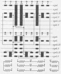
Abb. 1. Schema der Polumschaltung für einen Vierstufen-Drehstrommotor.
