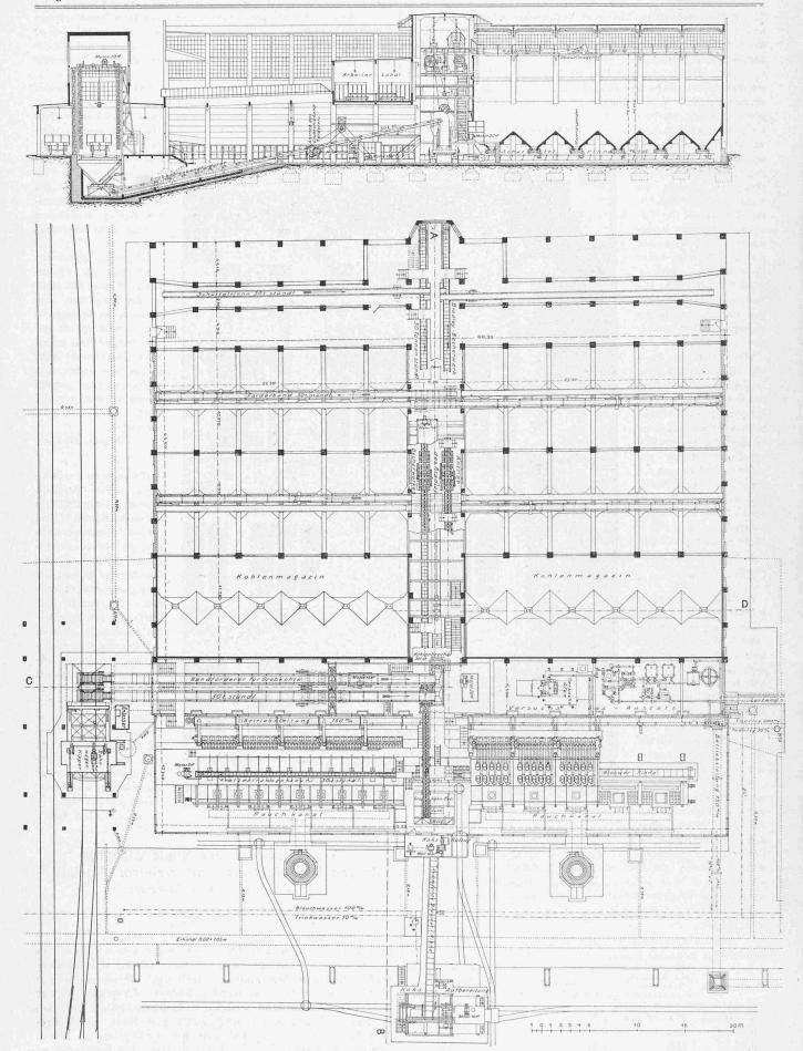
Abb 4. Kohlenschuppen Nr. II und Vertikalofenanlage. — Grundriss und Schnitt C-D. — Masstab 1:400,
