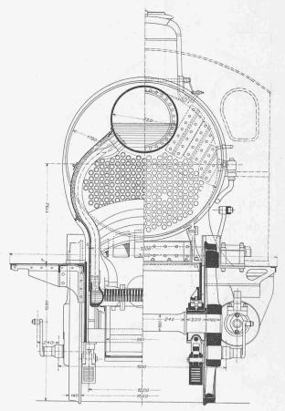
Abb. 6. A<sup>3</sup>/<sub>5</sub> Nassdampf-Vierzyl.-Verb.-Lokomotive mit Brotankessel. Querschnitte durch Feuerbüchse und hintere Triebachse. — 1:35.
