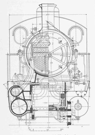
Abb. 10.  $C^4/_5$  Heissdampf-Zwillingslokomotive. Querschnitte. — Masstab 1:35.
