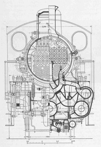
Abb. 2. A3/5 Heissdampf-Drillings-Lokomotive. Querschnitte. - Masstab 1:35.
