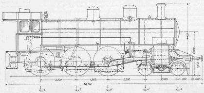
Abb. 1. A3/5 Heissdampf-Drilllings-Lokomotive. Typenskizze 1:100.
