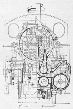
Abb. 4. A3/5 Heissdampf-Vierzylinder-Verbund-Lokomotive. Querschnitte. - Masstab 1:35.
