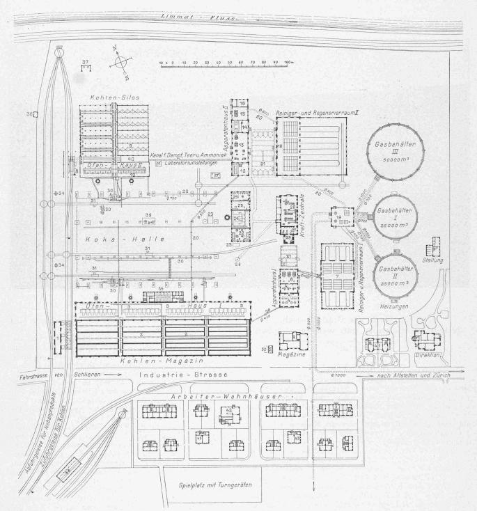
Abb. 2. Uebersichtsplan des Gaswerkes in Schlieren mit den Erweiterungsbauten. — Masstab I: 2000.
