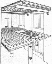
bestehend aus einzelnen, zum voraus fabrikmässig hergestellten Zement-Hohlbalken (Siegwartbalken), mit armierten Seiten-Wandungen für beliebige Spannweiten bis 6,50 m.
