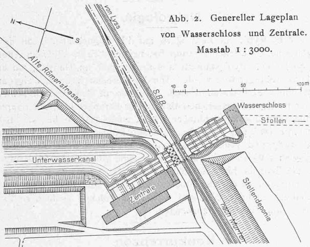
Abb. 2. Genereller Lageplan von Wasserschloss und Zentrale.
