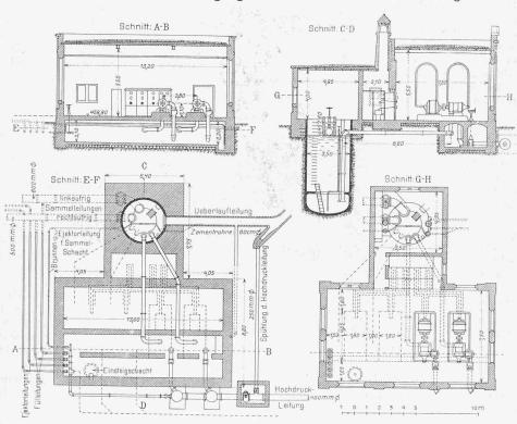
Abb. 4. Sammelschacht und Pumpengebäude bei Littau. — Masstab 1:300.
