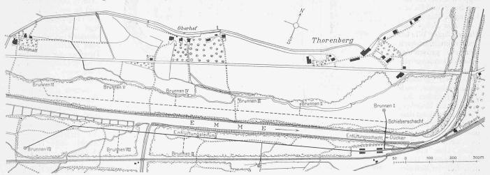
Abb. 2. Uehersichtsplan der Wasserfassung bei Thorenberg. — Masstab 1:10000.
