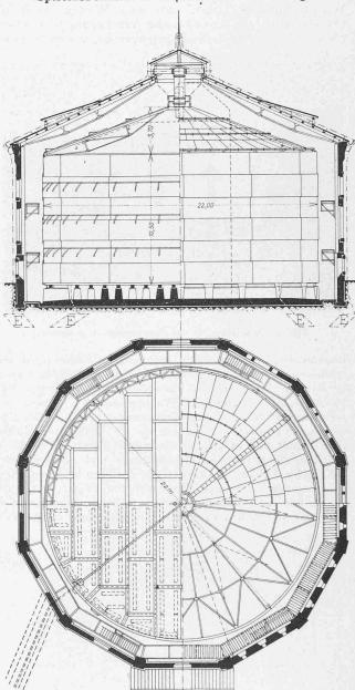
Abb. 3. Horizontal- und Vertikalschnitte des Behälters. - 1:300.
