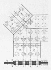
Abb. 4. Nietenanordnung in einem Eckstoss des Bodens. — 1:10.
