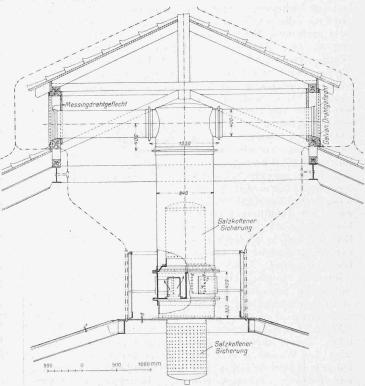
Abb. 7. Ventilationsaufsatz mit den Blitzsicherungen. — 1:50.
