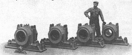
Feste Stehlager mit Ringschmierung und herausnehmbaren Weissmetallschalen.
