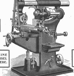
UNIVERSAL-FRÄSMASCHINE NR. 2 MIT VORSCHUBWECHSEL DURCH ZAHNRÄDERGETRIEBE. EINFACHE PLAN-UNIVERSAL-UND VERTIKAL-FRÄSMASCHINEN SOWIE AUTOMATISCHE RÄDER-:: :: :: FRÄSMASCHINEN. :: ::
