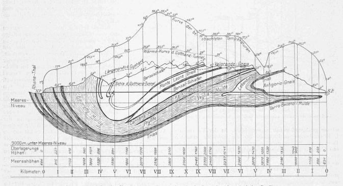
Abb. 21. Profil längs der Achse des Simplontunnels (Einpunktiert Gotthardtunnel) und geologisches Profil. — 1:120000. Wärmekurven für beobachtete Temperaturen beim Simplontunnel und beim Gotthardtunnel. (Geologisches Profil gezeichnet nach dem von den Herren Schmidt und Preiswerk aufgestellten Profile.)
