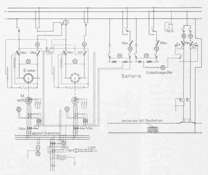
Abb. 29. Schaltungsschema der Umformerstation «Les Planches».
