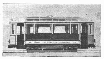
Motorwagen mit 20 Sitz- und 15 Stehplätzen. Type: Mit Längssitzen, mittlere Seitenfenster fest, Eckfenster herablassbar, Plattformen mit vorderer Verglasung und seitlich mit Flügeltüren, vollständig abschliessbar; Radstand 3,2 m.
