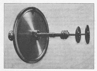
Fig. 7. Partie tournante de la turbine.
