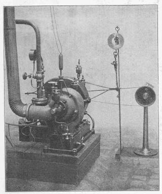
Fig. 3. Turbine à pétrole d'essai. Vue de face.
