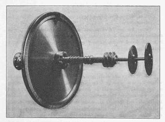
Fig. 7. Partie tournante de la turbine.
