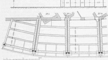
Abb. 8. Eisenbeton-Terrasse im Bahnhof Montreux. - Masstab 1:300.
