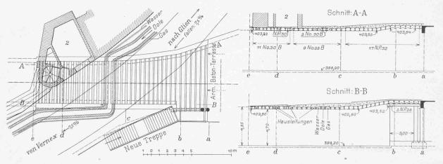
Abb. 4. Tunnel Nr. 1 unter der Kantonsstrasse und dem Hause Nr. 2. — Grundriss und Längsschnitte. — 1:300.
