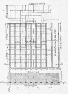
Abb. 33. Fugeneinteilung des grossen Gewölbes. — Masstab 1:50.
