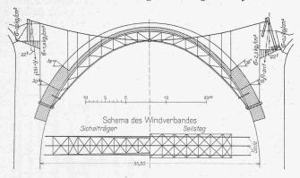
Abb. 36. Projekt der Bauleitung zu einem eisernen Lehrgerüst für die Mittelöffnung des Wiesener Viaduktes. — 1:750.
