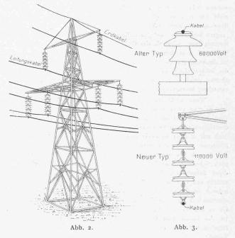
mit Sicherheit die 110000 Volt gegen Erde isoliert. Am untersten Gliede wird das Kabel hängend festgeklemmt. Als Blitzschutz ist über die Spitzen aller Türme ein eisernes Erdkabel geführt. Die Grösse des unter persönlicher Leitung von Ingenieur C. L. v. Muralt stehenden Unternehmens mag illustriert werden dadurch, dass die Leitungen insgesamt ungefähr 500 t Aluminium und die 3200 Gittertürme gegen 7500 t Stahl beanspruchen.
