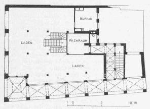
Abb. 2. «Rot-Haus». Grundriss vom Erdgeschoss. — 1:300.
