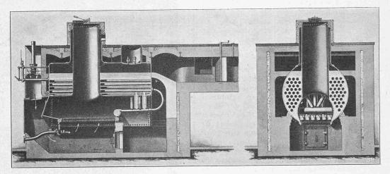
Abb. 29. Schmiedeiserner Kessel für Niederdruckdampf-Heizung von Gebr. Sulzer, Winterthur. — Masstab 1:50.
