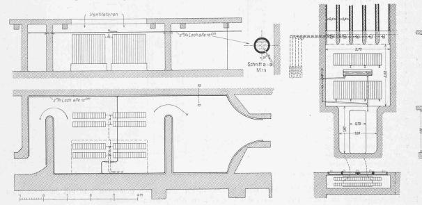
Abb. 12. Vorwärm- und Berieselungskammer. — Grundriss und Schnitt 1:100.
