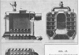
Gusseiserner Gliederkessel für Warmwasser- und Niederdruck-Dampfheizung von Gebr. Sulzer in Winterthur.
