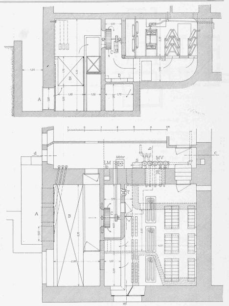
Abb. 19. Inselschulhaus in Basel. — Grundriss und Längsschnitt durch die Heizkammer. — 1:100.
