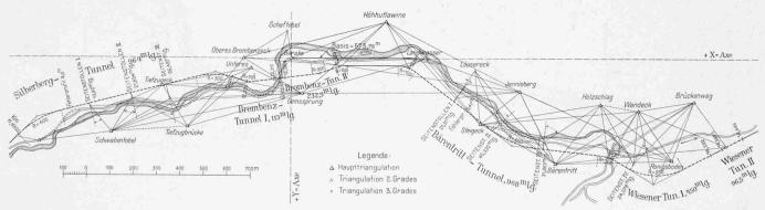
Abb. 10. Triangulation der Tunnelstrecke in den «Zügen». — Masstab 1:16000.
