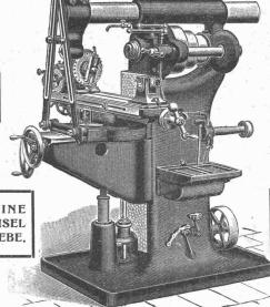
UNIVERSAL-FRÄSMASCHINE NR. 2 MIT VORSCHUBWECHSEL DURCH ZAHNRÄDERGETRIEBE. EINFACHE PLAN-UNIVERSAL-UND VERTIKAL-FRÄSMASCHINEN SOWIE AUTOMATISCHE RÄDER-:: :: :: FRÄSMASCHINEN. :: ::
