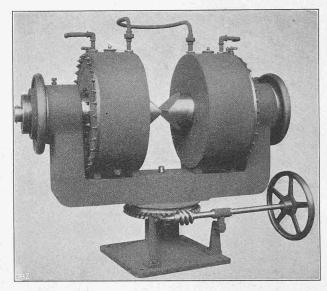
Abb. 4. «Elektromagnet Weiss» (grosses Modell) für die «Ecole Normale Supérieure» in Paris.
