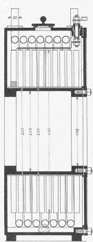
Abb. 5. Schnitt durch eine Spule des Magneten Abb. 4. — 1:6.
