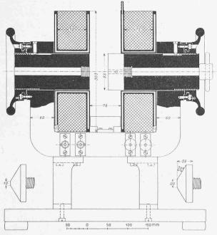
Abb. 6. «Elektromagnet Weiss» (kleines Modell). — 1:6.
