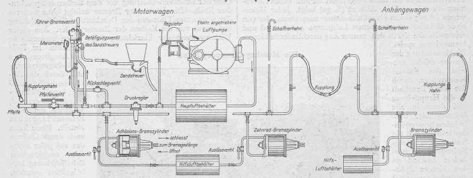
Abb. 28. Anordnung der automatischen, kontinuierlichen Differential-Drucklust-Westinghouse-Kleinbahnbremse.
