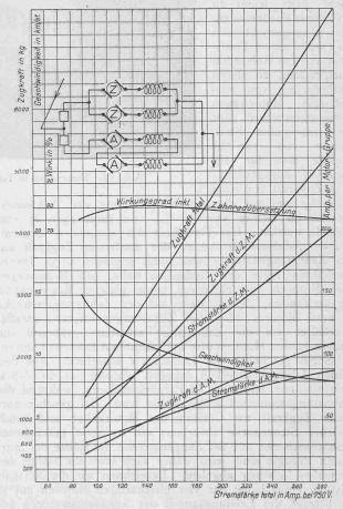
Abb. 20. Motorkurven uud Schema der Motorenschaltung auf der Zahnstangenstrecke.
