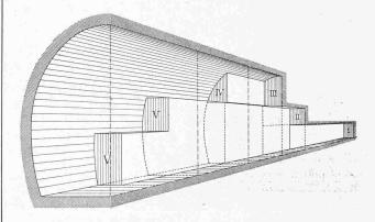
Abb. 3. Schematische Darstellung der Firstschlitzmethode.
