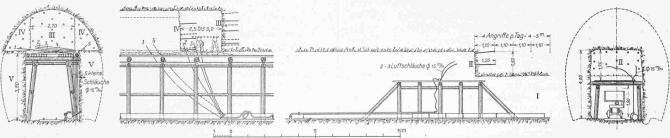
Abb. 4. Ausbruch der Wasserfluhtunnels nach der Firstschlitzmethode, vor dem Durchschlag. — Masstab 1:200.
