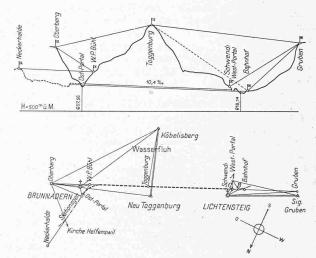
Abb. I. Lageplan und Längenprofil des Wassersluhtunnels. Masstab für die Längen I:80000, für die Höhen I:20000.
