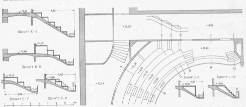
Abb. 9. Grundriss und Schnitte des III. Ranges. — Masstab 1:200.
