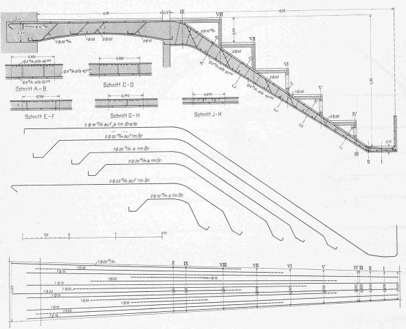
Abb. 10. Armierungsplan des III. Ranges. - Masstab 1:50.
