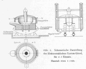
Magnesitstampfmasse und Formsteinen aus dem nämlichen Material. Mit dem Ofen fest verbunden ist rechts und links je ein senkrechter Ständer aus Winkeleisen, der zur Aufnahme der horizontalen Elektrodenführung aus Schmiedeisen dient, die ihrerseits an zwei vertikalen Spindeln ge-
