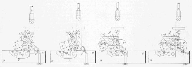
Abb. 7 bis 10. Durchbildung der Schiebersperre. — Masstab 1:4.
