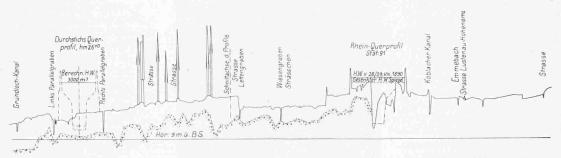
Talquerprofil durch die Mitte des Dorses Diepoldsau. - Masstab für die Längen 1:25 000, für die Höhen 1:500.
