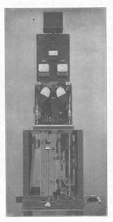
Abb. 4. Vorderansicht eines Martinschen Zugstabapparates.
