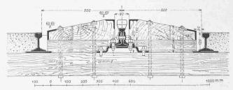
Abb. 15. Niveauübergang der Zahnstangenstrecke. — 1:15.
