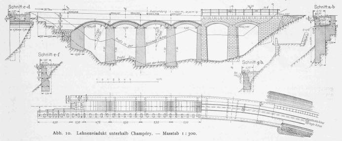
Oeffnungen von je 10 m auf 10,5 m hohen Pfeilern, der in einer Kurve von 80 m und in 30% Steigung liegt, und ein ähnlicher Viadukt bei Fayot, den Abbildung 5 im Bau zeigt. Das Mauerwerk der Pfeiler ist in Kalkmörtel, das Schichtenmauerwerk der Gewölbe in Zementmörtel erstellt, die obere Laibung erhielt 4 cm starken Zementverputz und Steinrollierung zur Entwässerung des schichtenweise ein-
