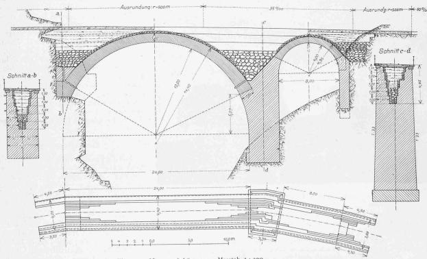
Abb. 8. Die Brücke «La Tine». — Mauerwerkskörper. — Masstab I: 300.
