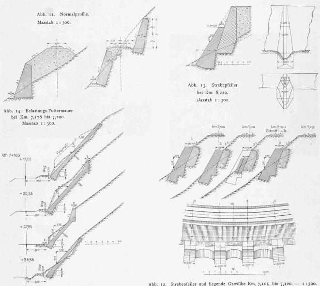
getreppten Pfeilern am vorteilhaftesten, weil auf diese Weise am wenigsten verlorenes Mauerwerk geleistet werden musste. Dieses Bauwerk stellte sich mit 355  $m^3$  Kalkmörtel- und 66  $m^3$  Gewölbemauerwerk auf eine Gesamtbausumme von 14370 Fr.
