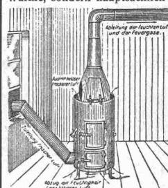
**Vorteile:** In wenigen Tagen gründliches Entfernen der Feuchtigkeit. Kein Ausströmen schädlicher Gase. Vollkommene Erhöhung des noch frischen Verputzes; einfache nicht ständige Überwachung bei Tag und Nacht; mehrjährige Gebrauchsfähigkeit; leichte Ersetzbarkeit der dem Feuer ausgesetzten Teile. Beste Ausnutzung des Koksmaterials. In 24 Stunden nur 1 bis  $1\frac{1}{2}$  Zentner Koks nötig. Ein Ofen für 100 cbm Raum. Zu beziehen à Fr. 100.— ab München durch
