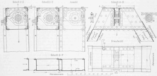
Abb. 3. Schnitte, Ansicht und Draufsicht des «A»-Bockwehrs von F. B. Thomas. - Masstab I : 20.
