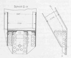
Abb. 4. Bockfuss in Schnitt und Ansicht. - 1:20.
