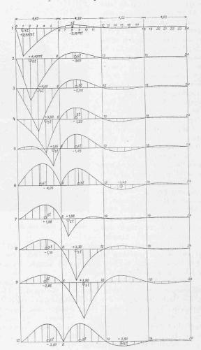
Abb. 23. Einflusslinien der Momente im Fahrbahulängsträger. Masstab für die Längen 1:250, für die Ordinaten 2 cm=1 m.
