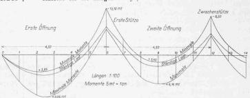
Abb. 24. Maximale und minimale Momente im Fahrbahnlängsträger.
