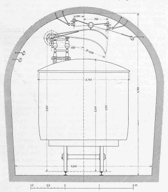
Abb. 9. Fahrdrahtaushängung im Tunnel. — Masstab 1:50.
