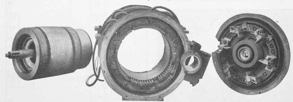
Abb. 15. Details des Einphasenstrom-Motors für 60 PSe.
