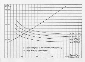
Abb. 21. Charakteristische Kurven des Wechselstrommotors Typ W.B. 40 von 60 PS, 250 Volt, 20 Perioden, bei Betrieb als kompensierter Gleichstrombahnmotor.
