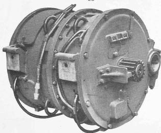
Abb. 14. Einphasenstrom-Motor für 60 PSe.
