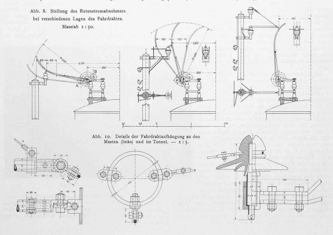
findet sich der Draht in, oder ungefähr in der Achse des Geleises. Die minimale Drahthöhe über Schienenoberkante ist nur 4,3 m auf der freien Strecke und nur 4,9 m in den Bahnhöfen, die maximale Höhe in den Weichen 5,3 m.
