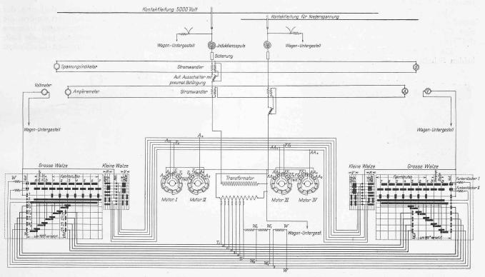
Abb. 19. Verbindungsschema der Schaltungen des Motorwagens. (NB. die Niederspannung beträgt 800 Volt.)
