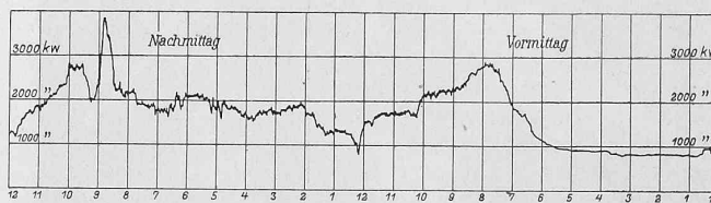
Abb. 68. Belastungs-Diagramm «Ruhig» vom 19. Dezember 1907. Maximale Belastung 3900 kw. — Anzahl kw./Std. 41 900.
