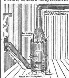
**Vorteile:** In wenigen Tagen gründliches Entfernen der Feuchtigkeit. Kein Ausströmen schädlicher Gase. Vollkommene Erhöhung des noch frischen Verputzes, einfache nicht ständige Überwachung bei Tag und Nacht; mehrjährige Gebrauchsfähigkeit; leichte Ersetzbarkeit der dem Feuer ausgesetzten Teile. Beste Ausnutzung des Koksmaterials. In 24 Stunden nur 1 bis 1½ Zentner Kokk nötig. Ein Ofen für 100 cbm Raum. Zu beziehen à Fr. 100.— ab München durch
