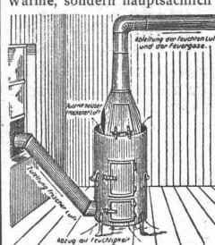
**Vorteile:** In wenigen Tagen gründliches Entfernen der Feuchtigkeit. Kein Ausströmen schädlicher Gase. Vollkommene Erhöhung des noch frischen Verputzes, einfache nicht ständige Überwachung bei Tag und Nacht; mehrjährige Gebrauchsfähigkeit; leichte Ersetzbarkeit der dem Feuer ausgesetzten Teile. Beste Ausnutzung des Koksmaterials. In 24 Stunden nur 1 bis 1½ Zentner Koksofen nötig. Ein Ofen für 100 cbm Raum. Zu beziehen à Fr. 100.— ab München durch
