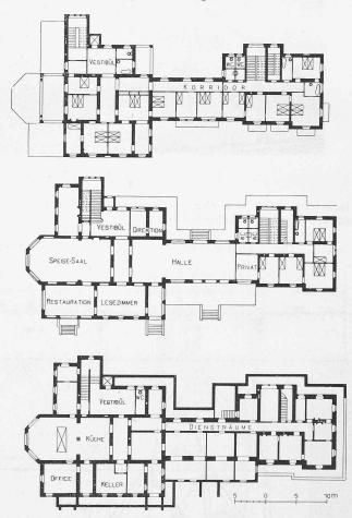
Abb. 2, 3 und 4. Grundrisse vom Untergeschoss, Erdgeschoss und ersten Obergeschoss des Hotels Béha in Lugano. Masstab 1:600.
