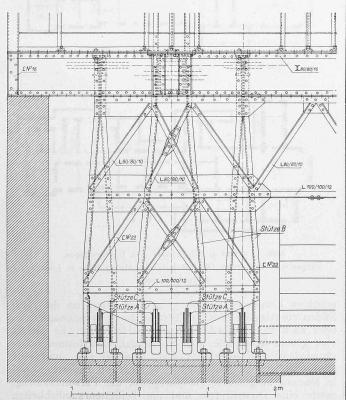
Abb. 9. Vorderansicht der Stütze B (aus Abb. 6). - Masstab 1:50.
