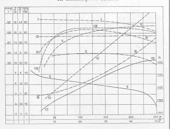
Abb. 7. Kraftbedarf- und Wirkungsgradkurven.
