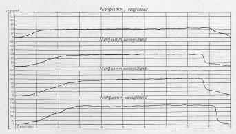
Abb. 6. Kolbendruckdiagramme für Nieten von verschiedenem Durchmesser und in verschiedenen Wärmezuständen.
