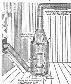
**Vorteile:** In wenigen Tagen gründliches Entfernen der Feuchtigkeit. Kein Ausströmen schädlicher Gase. Vollkommene Erhöhung des noch frischen Verputzes, einfache nicht ständige Überwachung bei Tag und Nacht; mehrjährige Gebrauchsfähigkeit; leichte Ersatzbarkeit der dem Feuer ausgesetzten Teile. Beste Ausnutzung des Koksmaterials. In 24 Stunden nur 1 bis  $1\frac{1}{2}$  Zentner Koks nötig. Ein Ofen für 100 cbm Raum. Zu beziehen à Fr. 100.— ab München durch
