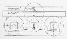
Abb. 20. Anordnung von Gestellmotoren mit Zahnradübersetzung für die Lokomotive von Seebach-Wettingen der Maschinenfabrik Oerlikon. Masstab 1:50.
