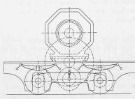
Abb. 19. Anordnung von Gestellmotoren mit Zahnradübersetzung der *ThomsonHouston Co.* von 1890 und der Maschinenfabrik *Kraus & Cie.* von 1895. Masstab I: 50.
