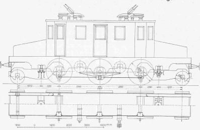
Abb. 21. Anordnung von Gestellmotoren ohne Zahnradübersetzung auf der Veltlinbahn nach Ganz & Cie. - Masstab I:50.
