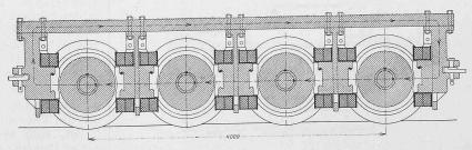
Abb. 12. Anordnung des magnetischen Kreises der Achsmotoren nach Abb. 11 für die Lokomotive 6000 der N. Y. C. & H. R. Rd. — 1:50.
