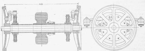
Abb. 9. Gleichstromachsmotor von 1889 nach S. H. Short. — Masstab 1:20.
