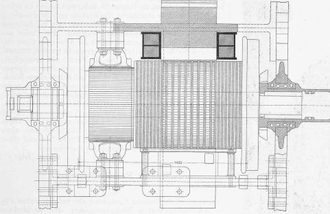
Abb. II. Gleichstromachsmotor der General Electric Co. für die Lokomotive Nr. 6000 der N. Y. C. & H. R. Rd. — Masstab I: 20.
