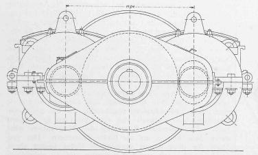
Abb. 6. Vorgelegedoppelmotor für Gleichstrom nach Křižik. — 1:20.
