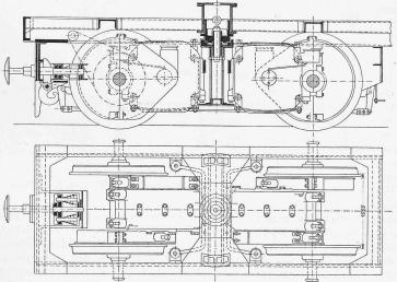
Abb. 4. Einbau von 2 Gleichstromvorgelegemotoren nach Abbildung 3 in ein Lokomotivdrehgestell. - Masstab 1:50.
