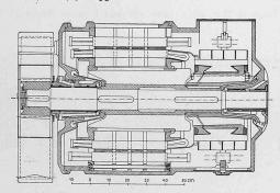
Abb. 8. Einphasenwechselstrom-Vorgelegemotor der Siemens-Schuckertwerke für Seebach-Wettingen. - 1:20.
