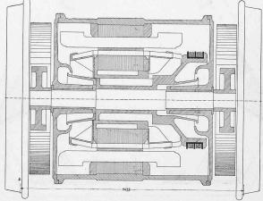
Abb. 7. Drehstromvorgelegemotor für die Siemens-Schnellbahnlokomotive Berlin-Zossen. — 1:20.
