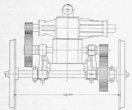
Abb. 1. Gleichstromvorgelegemotor von 1886 nach F. J. Sprague mit doppelter Uebersetzung. — 1:20.
