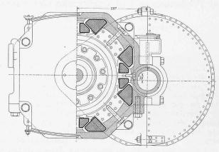
Abb. 3. Gleichstromvorgelegemotor der Siemens-Schuckertwerke für Schmalspurbahnlokomotiven. — 1:20.
