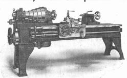
Schlittenvorschub durch Zahnradkasten und Hebel
