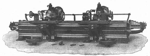
Doppelte Pleuelstangen-Bohr- und Fräsmaschine.
